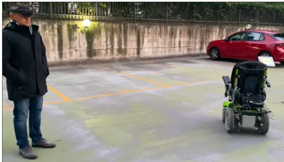
Con un visore, si può pilotare la carrozzina motorizzata usando gli occhi
