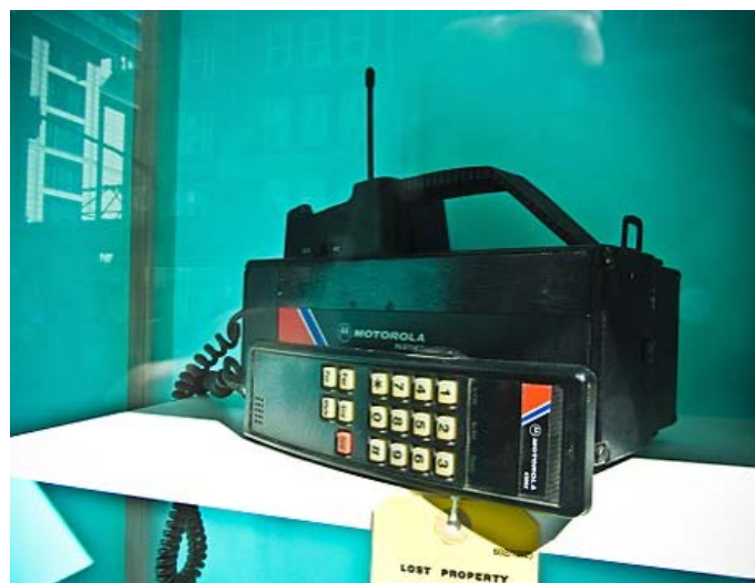
Uno dei primi telefoni mobili per telefonia circolare TACS (Total Access Communication System) che utilizzava la banda 450Mhz
