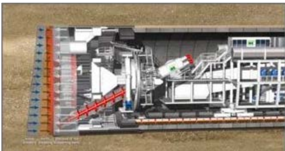
Fase di costruzione anello (figura 9)
